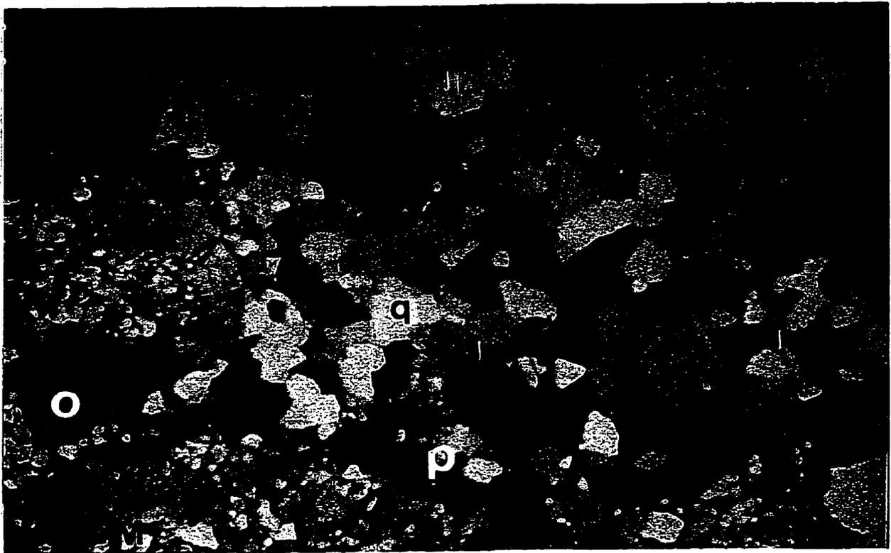
sous la forme de magnétite ou d'ilménite. Leur taille est d'environ un millimètre et sont hypidiomorphes.
